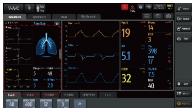
PulmoSight en los ventiladores Mindray Serie SV puede monitorizar de cerca los cambios en la mecánica respiratoria y mostrar la información en tiempo real, gráficamente.
